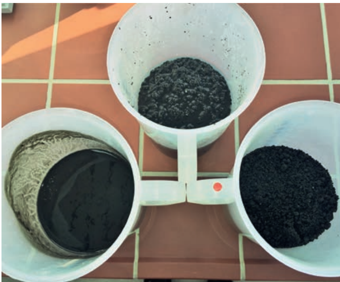
Links der flüssige Klärschlamm, mittig der mit Polymer behandelte Schlamm, rechts der gepresste Schlamm
