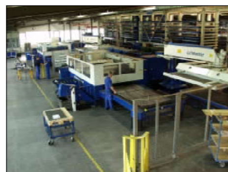
Vollautomatisierte Laserschneidanlagen mit Hochregallager
