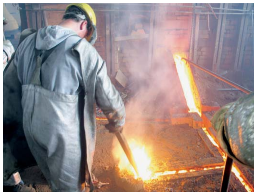
Nach dem Anstich des Gussofens schießt die flüssige Bronze wie glühende Lava durch die angelegten Kanäle und füllt nacheinander die in der Erde vergrabenen Glockenformen. Fotos: Hildenstein
